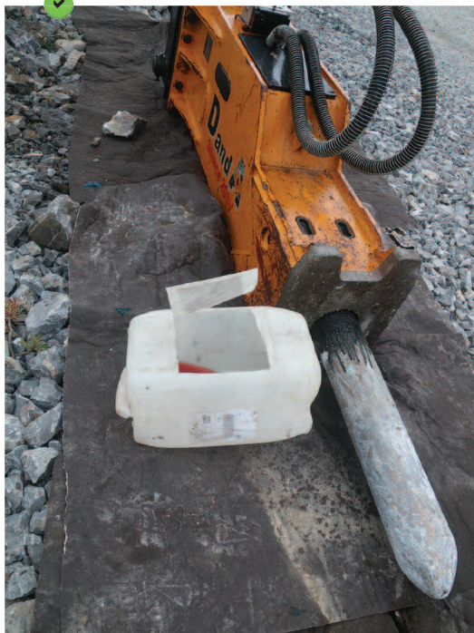
Équipement posé sur géotextile absorbant.
