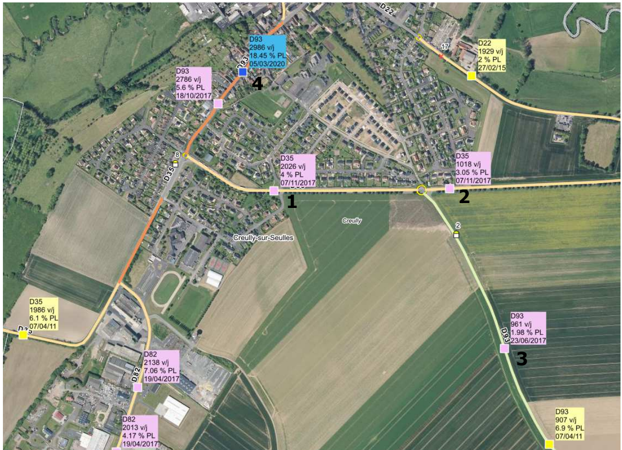
Localisation des points de mesure des flux routiers moyens (source : Atlas routier départemental - Conseil Départemental du Calvados)
