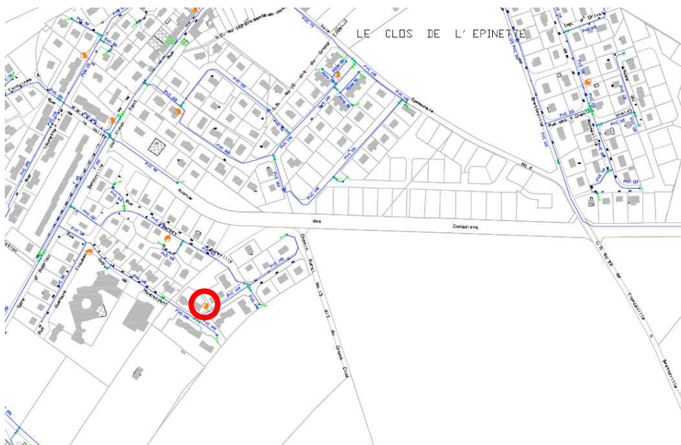
Localisation des poteaux incendie - Extrait du Plan du réseau Eau Potable – Source : PLU
